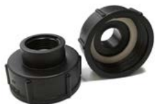
RACCORDO PER SERBATOIO S60 X 6 F USCITA 1" FEMMINA GUARNIZIONE EPDM
