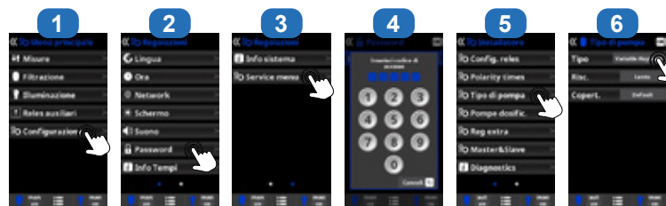
Schema di installazione di una pompa a velocità variabile su Control Station Panel NG
