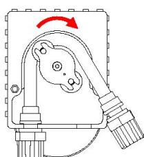
**FR** Positionner le raccord de gauche du nouveau tube péristaltique dans l'encoche prévue à cet effet. Faire attention à ce que la partie arrondie soit orientée vers l'intérieur. Tourner le porte-galet dans le sens horaire de façon à ce que le tube péristaltique se mette naturellement en place. Ne jamais tourner à contre-sens.
