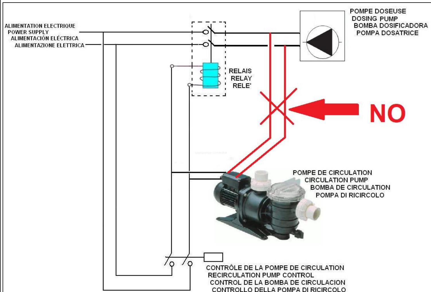
**IT** ! ATTENZIONE! La pompa deve iniettare quando l'acqua scorre attraverso l'impianto di filtrazione. Verificare che i valori di targa di alimentazione elettrica corrispondano a quelli dell'impianto. Per non danneggiare la scheda elettronica non collegare l'alimentazione elettrica direttamente in parallelo all'alimentazione elettrica della pompa di ricircolo ma utilizzare sempre un teleruttore/relè. L'avvenuta accensione della pompa è confermata dall'accensione del display.
