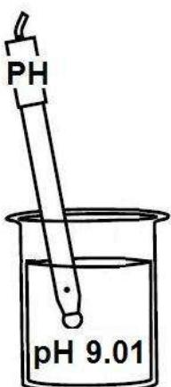
Enjuague con agua limpia la sonda de pH, retire suavemente las gotas de agua en exceso y sumergirla en la solución tampón a pH 9.1 o 4.1 o cualquier otro valor.
