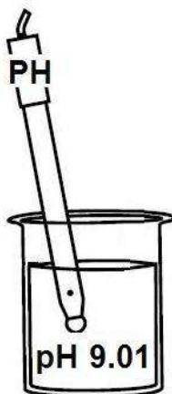
Sciacquare con acqua pulita la sonda di pH, eliminare delicatamente le gocce d'acqua in eccesso ed immergerla nella soluzione tampone a pH 9.01 oppure 4.01 o altro valore.
