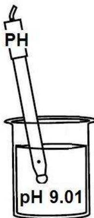
Rincer avec eau propre la sonde de pH, retirez délicatement les gouttelettes d'eau en excès et plonger la sonde dans la solution tampon à pH 9.01 ou 4,00 ou une autre valeur.
