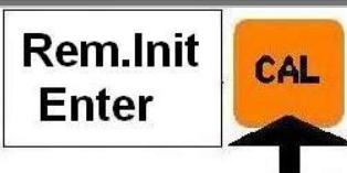
Pressez et relâchez rapidement la touche CAL puis le boutons + et – jusqu'à ce que apparaît l'inscription «Rem. Init. Enter». Appuyez sur CAL pour confirmer. La pompe revient automatiquement à mesurer avec les valeurs de programmation de la mémoire et l'étalonnage d'usine.
