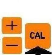
Choisir avec + et - **Yes** si la pompe doit doser lorsque le courant d'entrée est supérieur au courant mA Max et **No** si la pompe ne doit doser lorsque le courant d'entrée est supérieur au courant mA Max. Confirmer avec **CAL**
