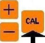
Elija con las teclas + y - el valor de la frecuencia de dosificación (**Imp Min**) que la bomba debe realizar cuando la entrada es la corriente mínima. Confirme con **CAL**.
